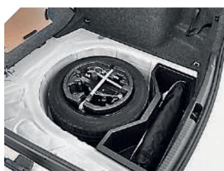
Под фальшполом багажника прячутся полноразмерная запаска, набор инструментов и вместительный контейнер
