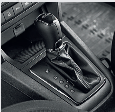
Бензиновый 1,2-литровый мотор семейства TSI сочетается с 7-ступенчатой коробкой DSG и передним приводом
